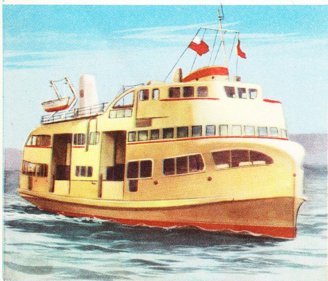
*Le bâtiment d'eau douce est construit en vue de la navigation sur les lacs et les fleuves: il présente des structures profondément différentes de celles d'une embarcation conçue pour affronter la mer. Ses rambardes sont plus basses, et la force de l'étrave est réduite au minimum nécessaire.*
