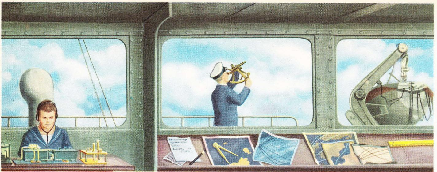
*Sur la passerelle de commandement, un officier fait le point avec un sextant. Cette passerelle est en communication directe avec le poste de radio et la salle des cartes, où se trouvent les cartes nautiques, les papiers de bord etc...*
