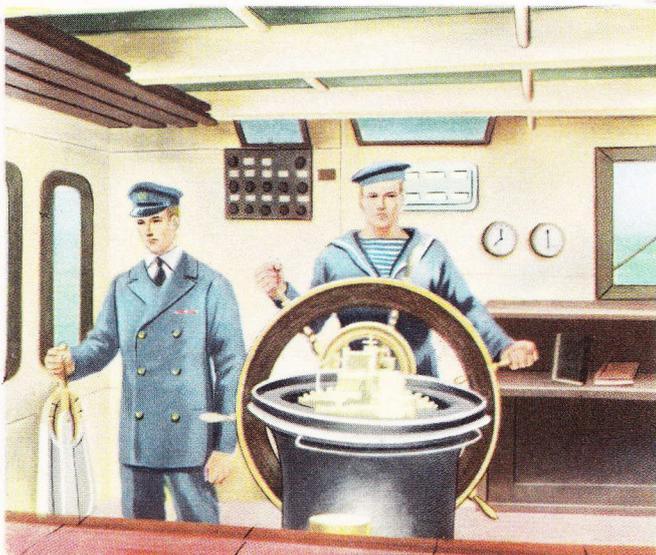
Au début du siècle, en dotant les navires de perfectionnements nouveaux, on a fait un effort en faveur des services auxiliaires. On a fait en sorte, par exemple, de manoeuvrer mécaniquement le gouvernail — dont le corps est actionné par un moteur placé à la poupe — de façon à rendre la route du navire plus uniforme.
